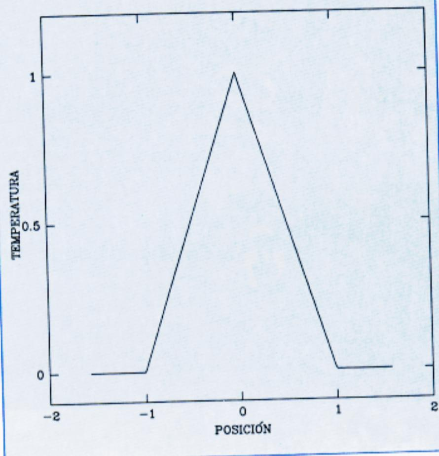
Distribución de la temperatura (eje vertical) como función de la posición (eje horizontal) para la barra de nuestro problema. Los bordes de la barra están en contacto con paredes infinitas que se mantienen siempre a 0 grados.
