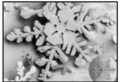
► Crecimiento en forma de dendritas, uno de los cuatro patrones típicos. (En el recuadro, vista con microscopio óptico).
